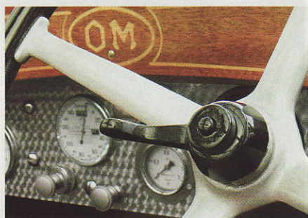
Feingefühl statt Elektronik: Zündverstellung am lackierten Vierspeichen-Lenkrad.
