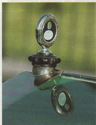
Simple und effizient: Wasserthermometer als Kühlerfigur.
